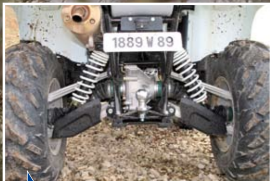
Suspension totalement indépendante, transmission par cardan, ce HY 700 est équipé comme les gros baroudeurs de ce monde.
