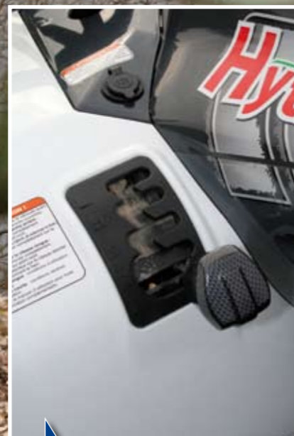
Le passage de vitesses s'effectue de manière onctueuse grâce à un système à cran avec une grille parfaitement visible.
