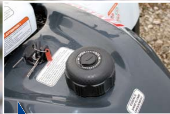
Le réservoir d'une contenance de 20 l. est visuellement impressionnant. Notez que celui-ci ferme à clé.
