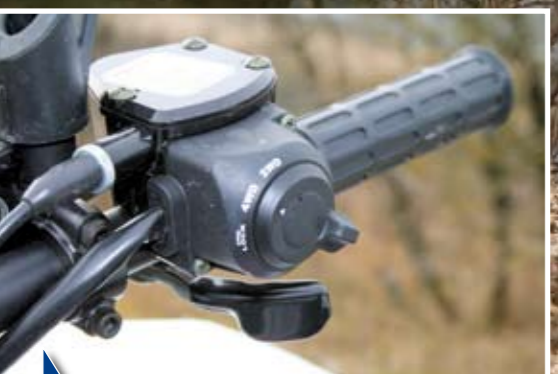
Ergonomique et esthétique, le système de passage en 4 roues motrices qui enclenche instantanément le pont avant quelle que soit la vitesse du véhicule.
