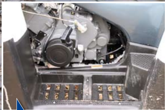
Les marchepieds laissent suffisamment de place au pilote ; quant au passager, il profitera de la rehausse prévue à cet effet. Sur cette vue, on remarque également le lanceur de secours disponible sur le HY 700.
